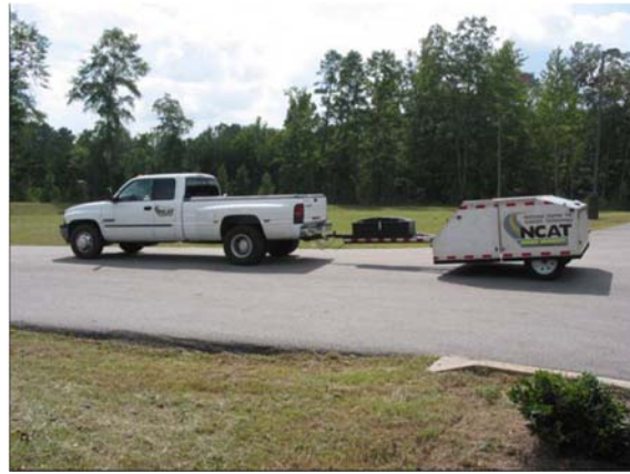
图 T 0987-3 拖车式CPX测试方法
